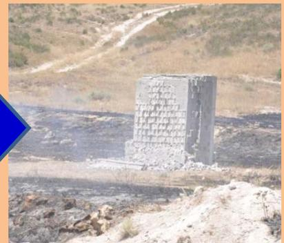
ブロック壁の裏面にLINE-Xを塗布。LINE-Xは、コンクリートの破壊及び飛散を防いだ。
