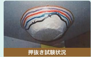
押抜き試験状況
