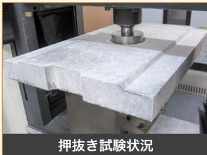
押抜き試験状況
