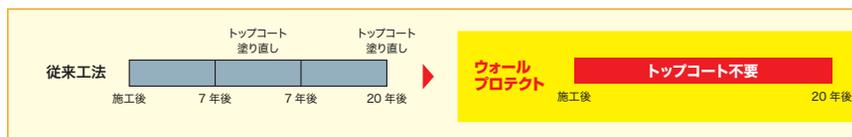
強制的に 3000 時間の紫外線を照射する耐久試験をクリアしています。この紫外線を自然界に換算すると約 20 年間に相当する耐久性を有しています。
