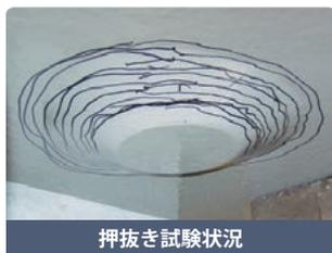
押抜き試験状況
