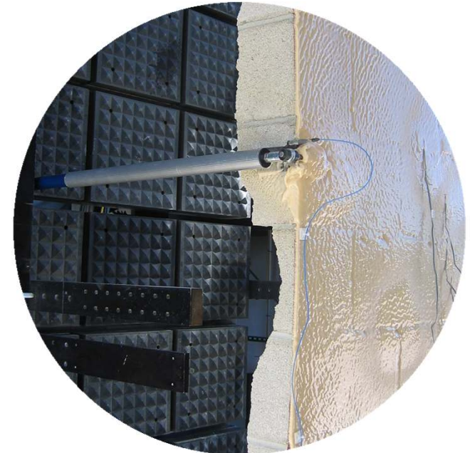
側面に衝撃機で衝撃を与えてもLINE-Xが形状を保つ
