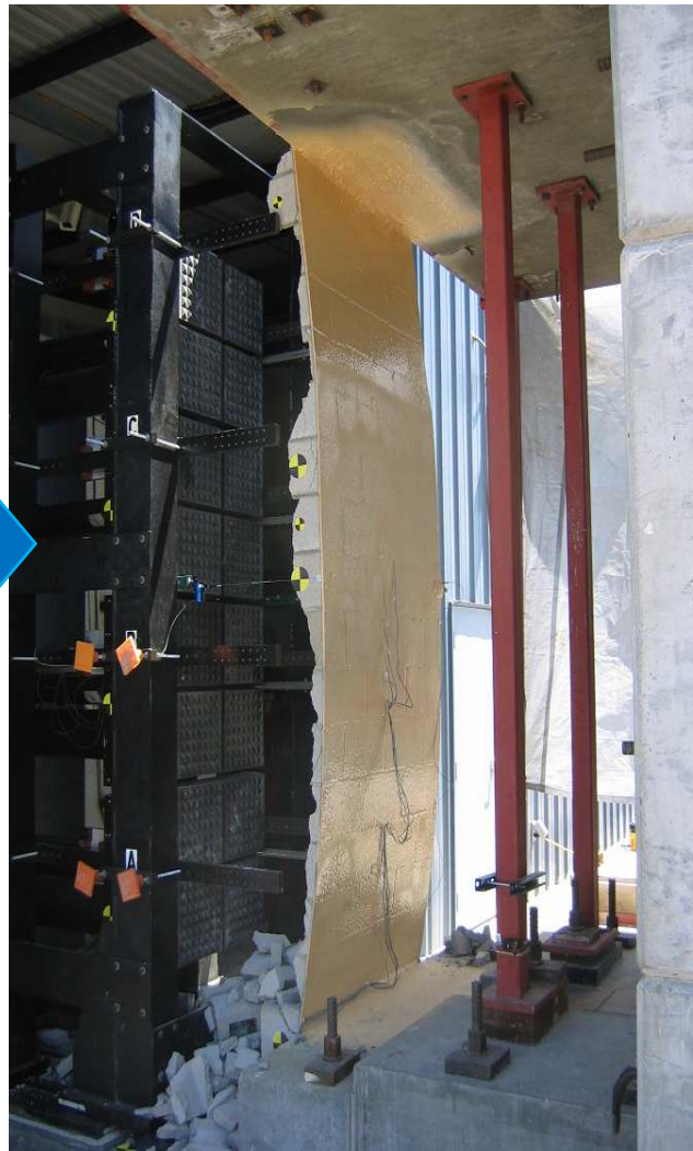
側面に衝撃機で衝撃を与えてもLINE-Xが形状を保つ
