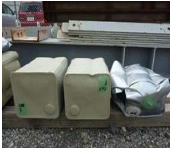
試験後の試験体(左:5mm, 中:3mm, 右:未塗装)
